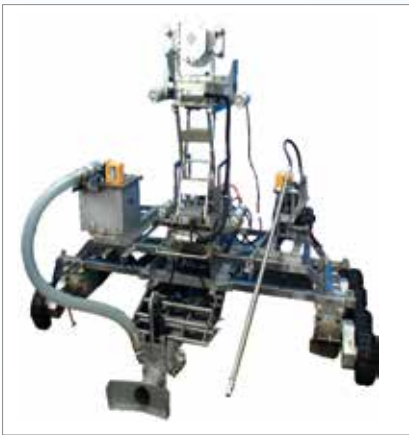
● グランドスイーパー（大口径管清掃ロボット）による清掃
